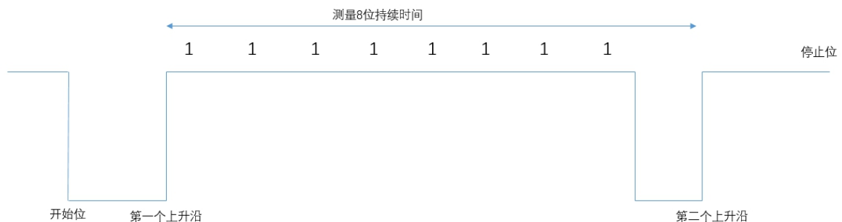
图 1 软件自动波特率检测原理
